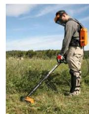
Le **désherbage mécanique à essence par balayage** permet de longer les bords de rue goudronnée, bétonnées et les trottoirs... Il ne dispense pas d'un deuxième passage pour balayer les herbes et présente aussi l'inconvénient d'être d'autant plus bruyant que le passage est relativement lent.
